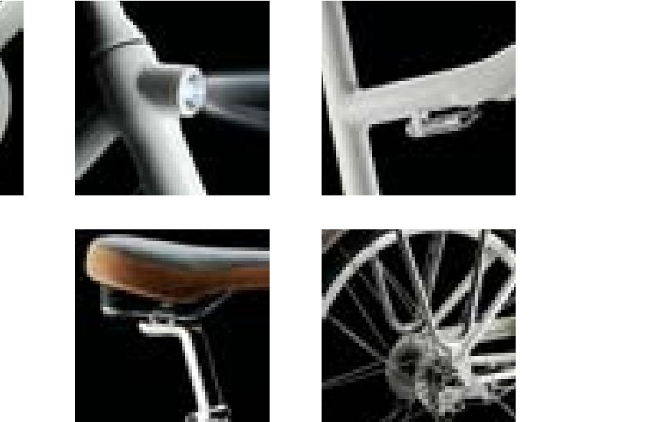
的城市骑车一族大加称赞。同样地，作为标准配件，车的前部和尾部都安装了卤素灯，同时还配有隐藏式的防盗车锁。时钟和车灯所需的电能都是由安装在车轮里的陀螺仪提供的，省去了使用者更换电池的麻烦。
