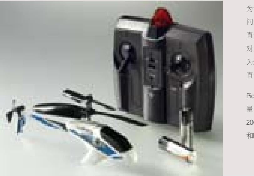
2004年，在生产了一系列遥控飞机后，银辉积累了足够经验和技术，开始制造玩具直升机。为了显得与众不同，公司试图制造一款能在室内飞行的玩具直升机。在做出此决定后，一系列设计创意得以落实。为了便于室内使用，产品的安全性、耐用性以及大小和重量都需要给予特别考虑。Picooz 直升机机身使用一种特殊泡沫塑料和耐用的塑料部件，可以经受高强度碰撞。直升机重量不到 10 克，长和高分别为 17.5 和 7 厘米，被吉尼斯纪录认定为世界上最小的直升机。为了解决过小的尺寸和重量带来的飞行问题，Picooz 直升机的两根螺旋桨以相同方向旋转，而不像普通直升机那样以相反方向旋转。这款迷你直升机的另一个特点是其对空气动力学的利用。直升机摒弃了普通直升机的机身造型（因为这严重影响了直升机灵活性），采用一种类似鱼的膨胀造型，使直升机具有更强的机动性。
